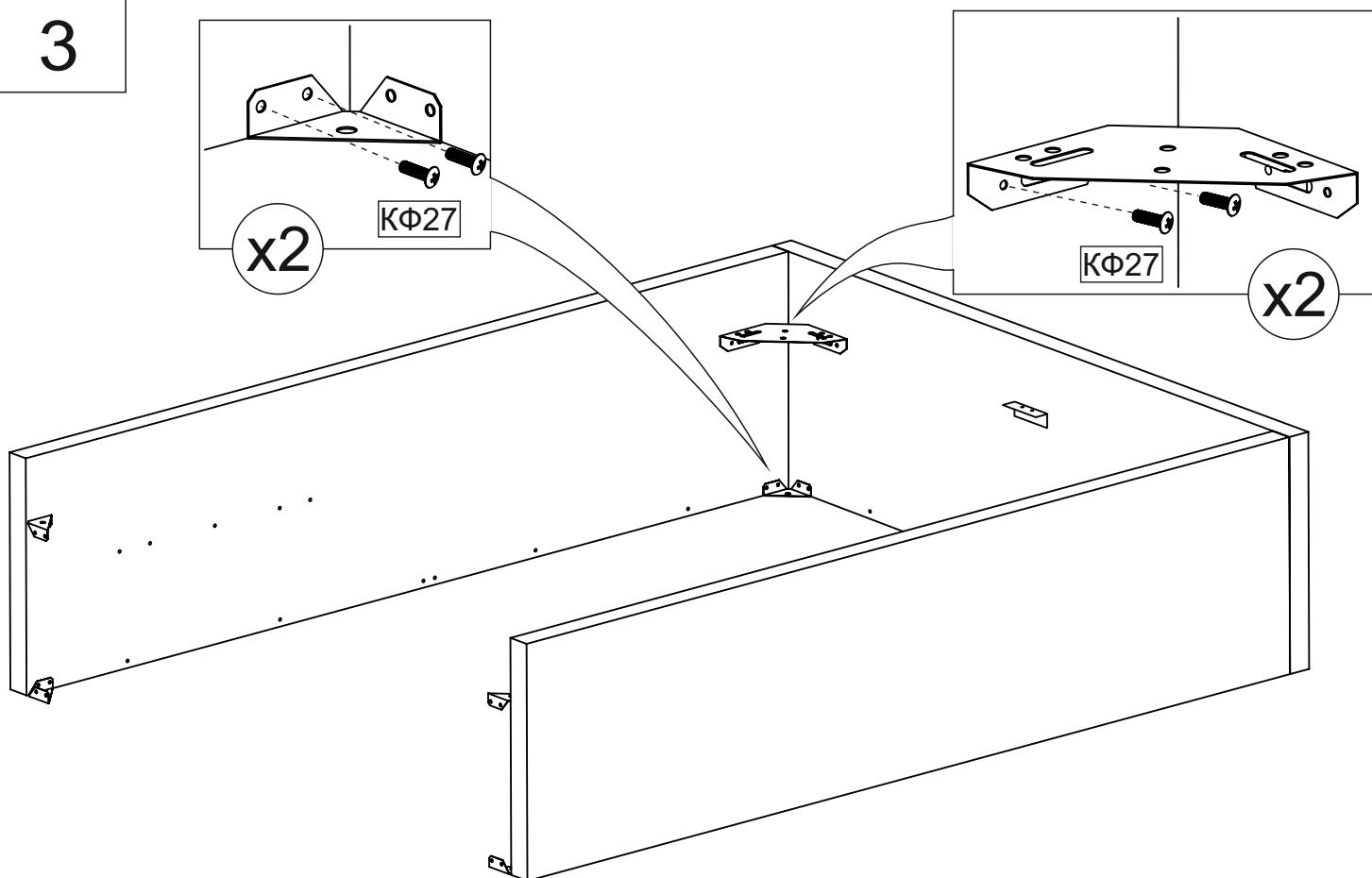
Большая угловая стяжка КФ3 крепится только к фронтальной царге на верхних отверстиях. Проследите за ровностью собранной конструкции.
