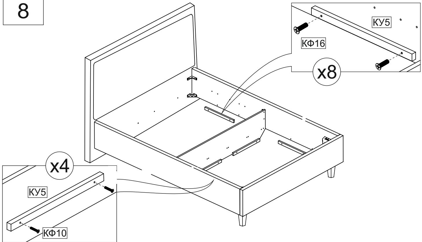
Упоры КУ5 для дна бельевого ящика можно установить до соединения царг, изголовья и распорки. К распорке КО4 упоры КУ5 крепятся винтом КФ10. На царги и изголовье КУ5 крепятся винтом КФ16.
