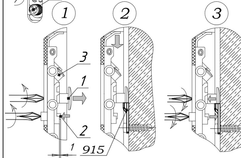
1 Используя отвертку, вывернуть винт для навески -1 (до упора) и стопорный винт -2 в крайнее положение, против часовой стрелки. Винтом -3 установите среднее положение вертикального хода навески.
