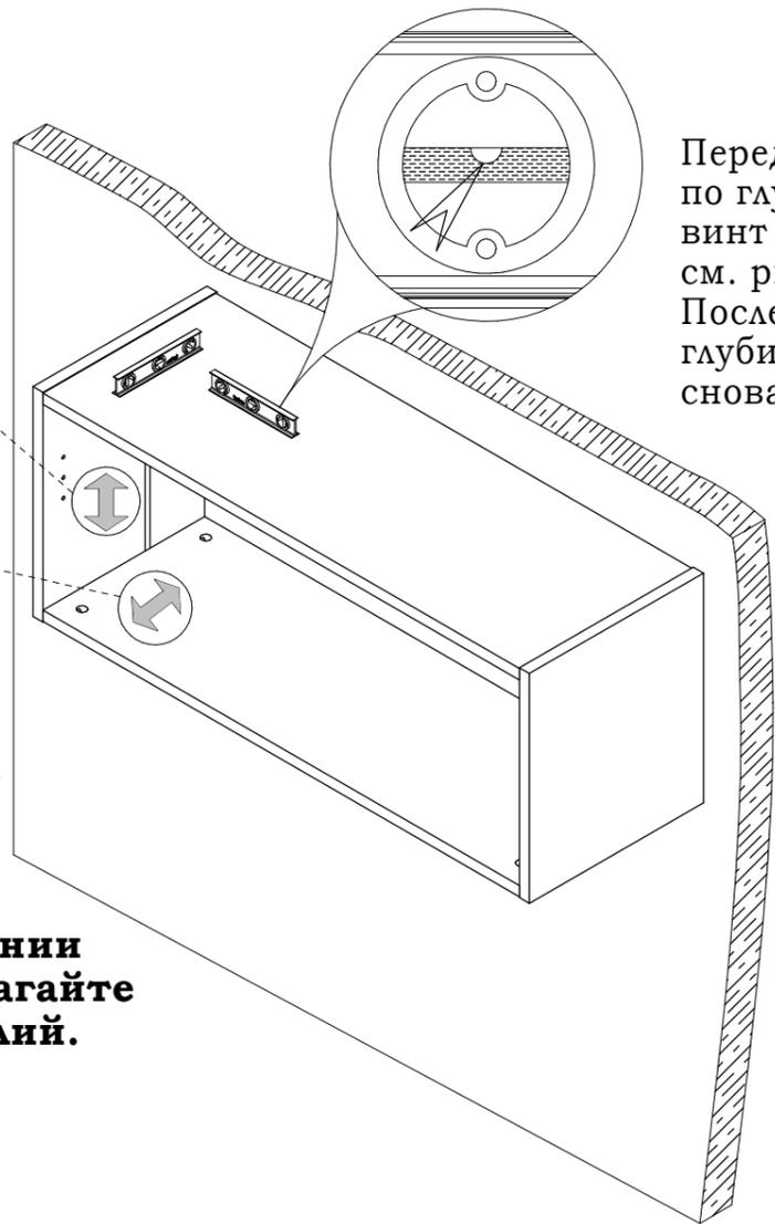
Перед регулировкой по глубине, открутите винт фиксации. см. рис. 2
