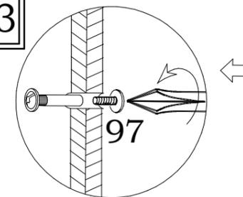
Для соединения шкафа с другими изделиями, через боковины просверлить электродрелью два отверстия  $\phi$  5 мм, предварительно выровняв шкаф и изделие по высоте. Соединить их при помощи межсекционных стяжек **97**.
