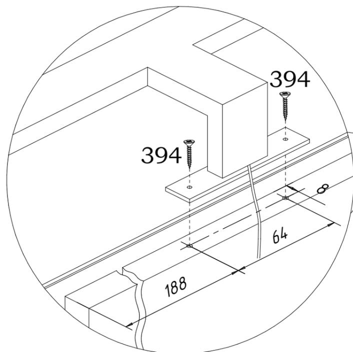
Разметьте и сделайте наколки шилом по приведённой схеме. Затем закрепите светильник саморезами **394**.
